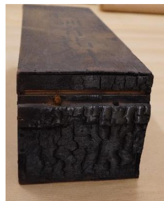
写真 5. 木箱 焼損部分
