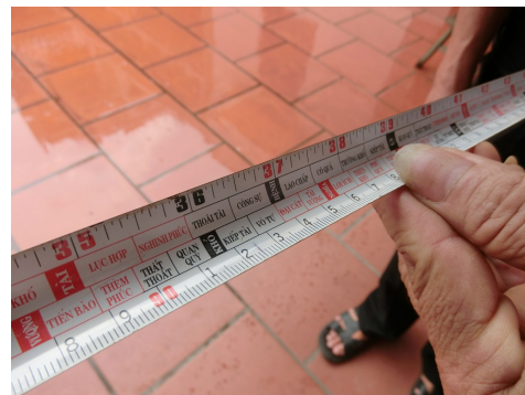
図2. 魯盤尺の巻き尺 ハイズオン省チーリン市にて筆者撮影
